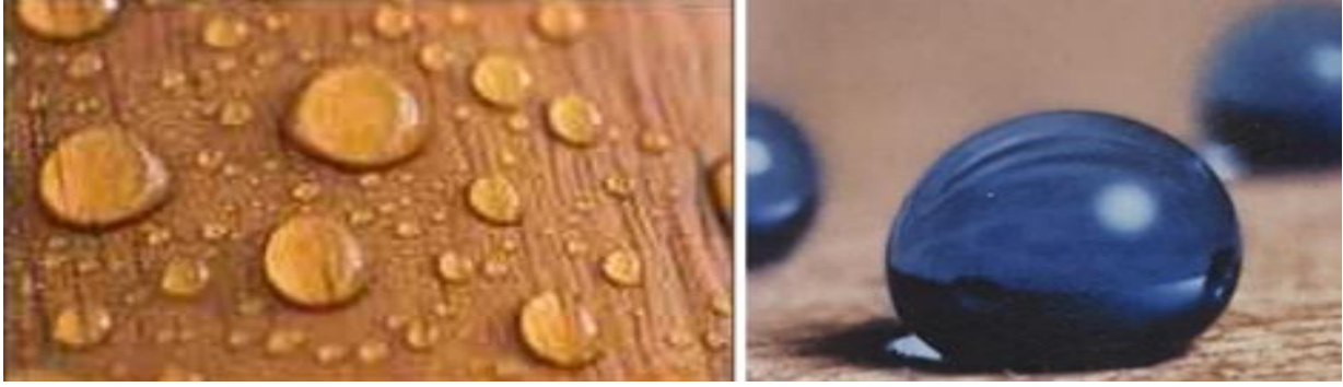
شكل (3) سطح الخشب المعالج بطبقة من طلاء النانو الطاردة للمياه.
